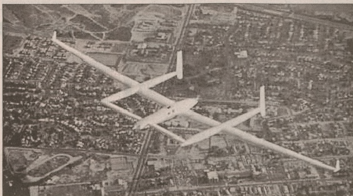
Voyager – superlekki samolot – został zaprojektowany do wykonania jednej misji: lotu dookoła świata bez lądowania i bez tankowania. Awionikę wykonano przy użyciu nowoczesnych materiałów, tak aby maszyna była jak najlżejsza, a jednocześnie by było odpowiednio dużo miejsca dla dwuosobowej załogi, prowiantu i przede wszystkim paliwa. Misja zakończyła się sukcesem – Voyager okrążył glob w dziewięć dni.
