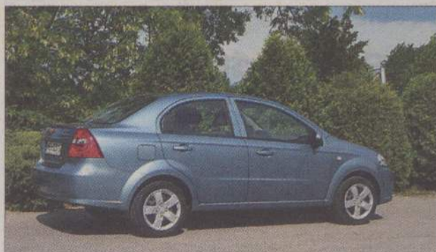
Na naszym rynku odnowiony Chevrolet Aveo sedan jest dostępny z dwoma silnikami benzynowymi: 1.2 l/72 KM i 1.4 l/94 KM.
