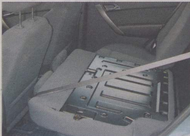
Bagażnik Aveo sedana ma pojemność 400 litrów. Można ją zwiększać składając oparcia tylnej kanapy.
