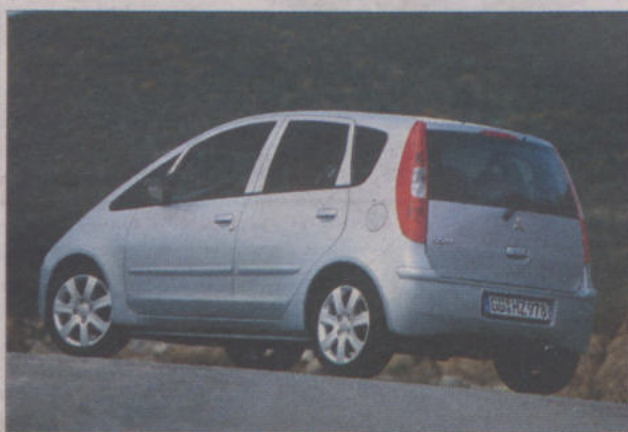
Colt napędzany silnikiem benzynowym 1.4 l o mocy 95 KM ma niezłą dynamikę, zużycie paliwa w mieście wynosi ok. 8 l na 100 km.
