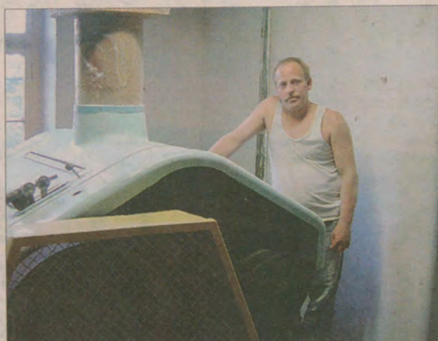
Ponad stuletni młyn w Grabinach Zameczku, tak jak przed laty produkuje mąkę. Najpierw zboże trafia do czyszczalni, gdzie ziarno oddziela się od plew, kamieni i słomy. Potem, w walcowni, zboże jest mielone. Nad prawidłową pracą urządzeń czuwa Ryszard Gonsiorowski.
