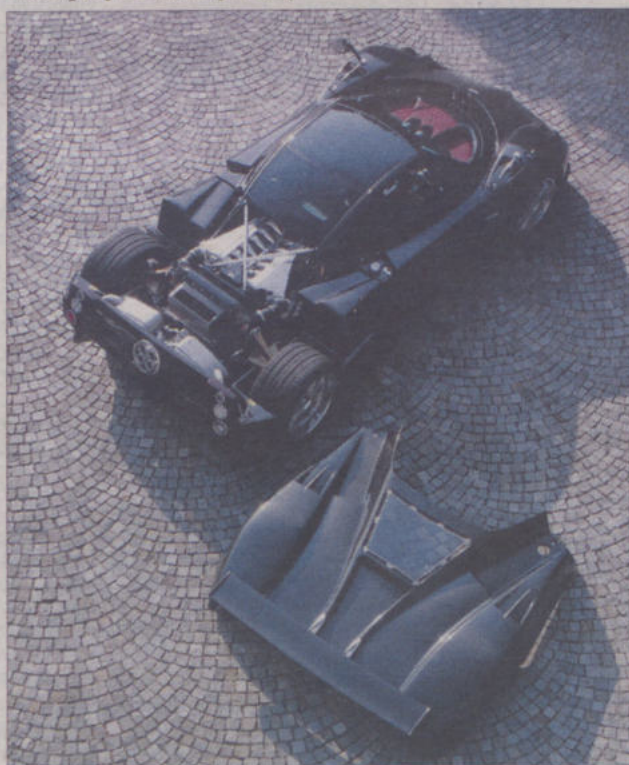
Zbudowana z kompozytu kabina jest kręgosłupem Zondy. Do niej mocowane są ramy pomocnicze z lekkich stopów, dzierzące zawieszenie i silnik. Napędzane są koła tylne.
