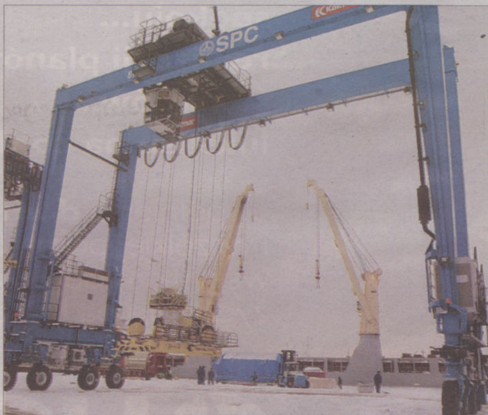
Każda z suwnic waży 130 ton i liczy sobie 25 metrów wysokości. Fot. Tomasz Bolt
