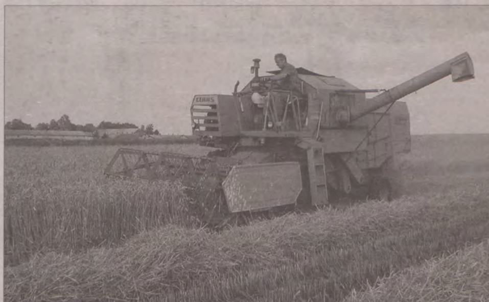
Nie wolno kombajnom poruszać się po drogach z zamontowanym hederem.
