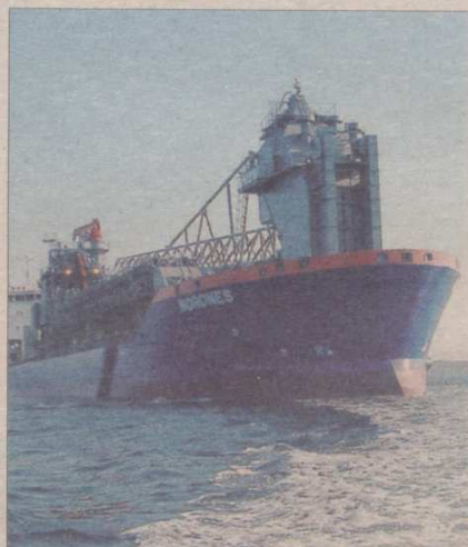
Służący do prac podwodnych statek „Nordnes”, odbudowany od stępki w Gdańskiej Stoczni Remontowa SA, podczas prób morskich.
