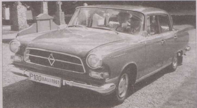
Ostatni samochód Borgwarda – P-100 wszedł do produkcji w roku 1960. Miał 6-cylindrowy silnik o poj. 2,3 litra i mocy 100 KM oraz pneumatyczne zawieszenie. W latach 1967-70 wytwarzano go w Meksyku.
