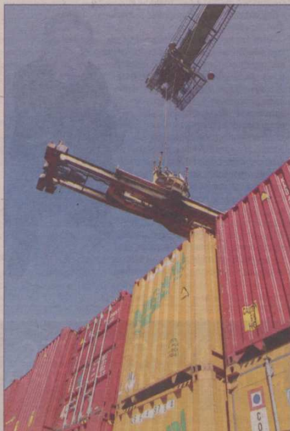
Kontenery układane są warstwami. Dzięki temu oszczędza się powierzchnię magazynową
