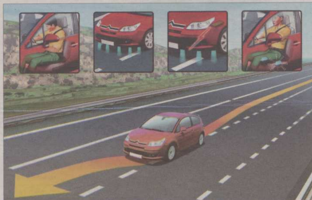
W Citroenie C4 prowadzący pojazd informowany jest o przekroczeniu pasa ruchu bez włączonego kierunkowskazu. W siedzisku fotela kierowcy generowane są ostrzeżenia o przekroczeniu linii.
