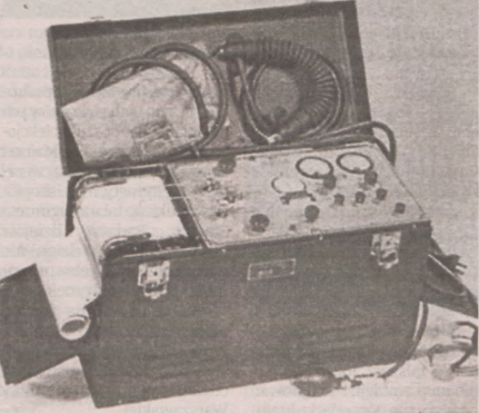
Wersja wariografu Keelera z 1925 roku. Mierzył trzy parametry: oddech, ciśnienie krwi i reakcje skórne
