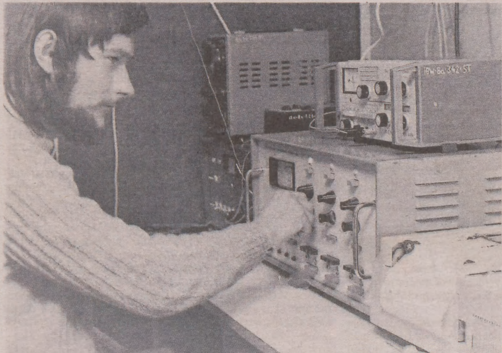
Andrej Redlich obsługujący hydrofalometr morski podczas badań warunków lokalizacji elektrowni jądrowej Kopań
