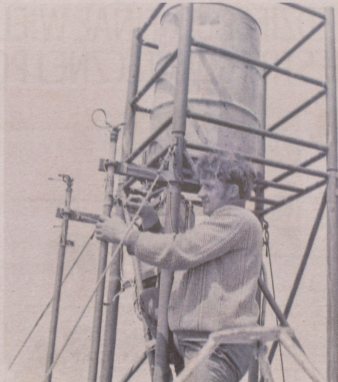
Kopań: Marian Nieścior mocuje sondę na wieży pomiarowej zainstalowanej na morzu
