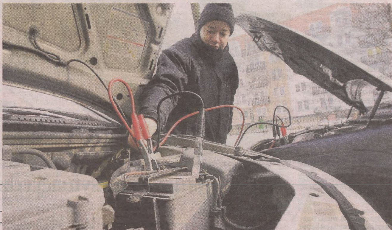
Po uruchomieniu silnika przez kable rozruchowe nie mamy gwarancji, że akumulator w naszym pojeździe został naładowany
