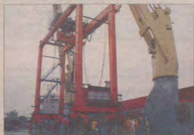
Dwa burtowe dźwigi statku „Lena” transportują na pokład suwnice.
