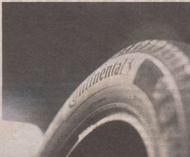
Do produkcji opony wykorzystuje się ok. 400 gramów przędzy poliestrowej. To tyle, co 60 butelek PET z recyklingu
