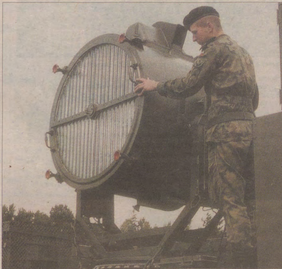
Reflektor typu APM, tzw. baniak oświetlający lotniska w nocy.
