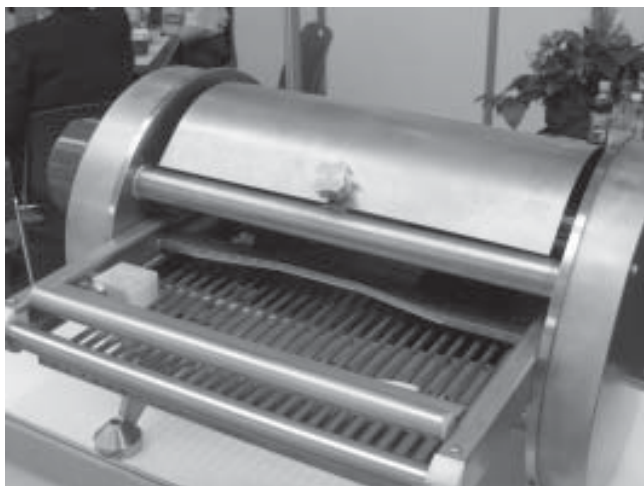
Rys. 2. Model doświadczalny maszyny do przecinania ości w tuszkach ryb karpioatych.
