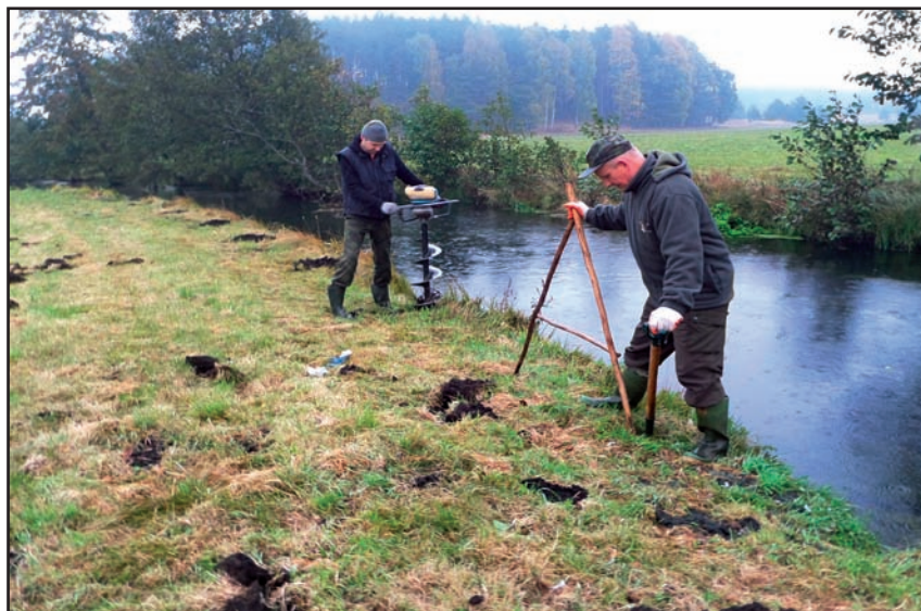
Ogromną pomocą było wykorzystanie mechanicznego urządzenia do wiercenia otworów w glebie fot. Marek Orlikowski
